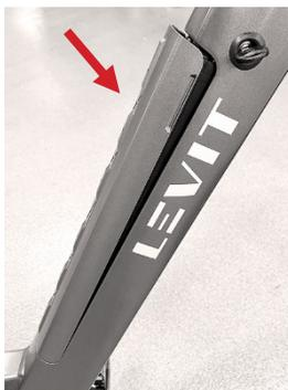
dans le vélo et bien verrouillée. Insérez d'abord les contacts de la batterie, puis cliquez dans le verrou. Assurez-vous que la batterie est verrouillée. La clé ne revient pas d'elle-même de l'état déverrouillé !
